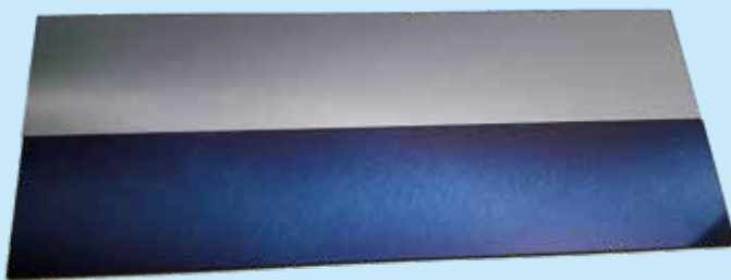
Ein unbeschichteter (oben) und ein mit Nanopapier beschichteter Siliziumwafer. Die Nanozelluloseschicht ist nur 200 Nanometer dünn. Die Wafer sind je zwei Zentimeter breit und zehn Zentimeter lang.
