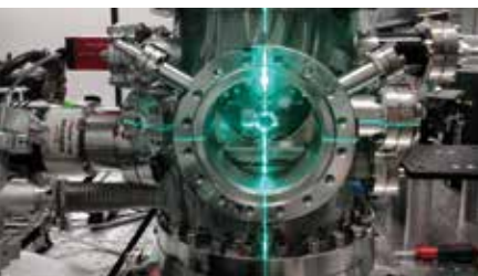
Das System passt auf einen Labortisch und wird mit Hilfe eines optischen Lasers justiert.
